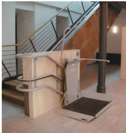
Platzbedarf bei eingeklappter Plattform nur 300 mm
