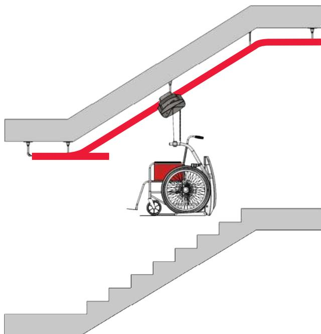
Fixation sur plafond en béton ou en bois possible
