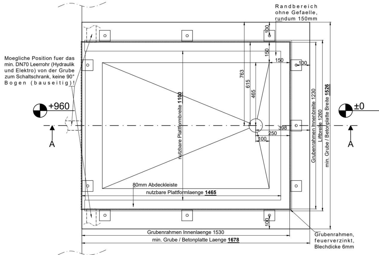
Moegliche Position fuer das min. DN70 Leerrohr (Hydraulik und Elektro) von der Grube zum Schaltschrank, keine 90° Bogen (bauseitig)!
