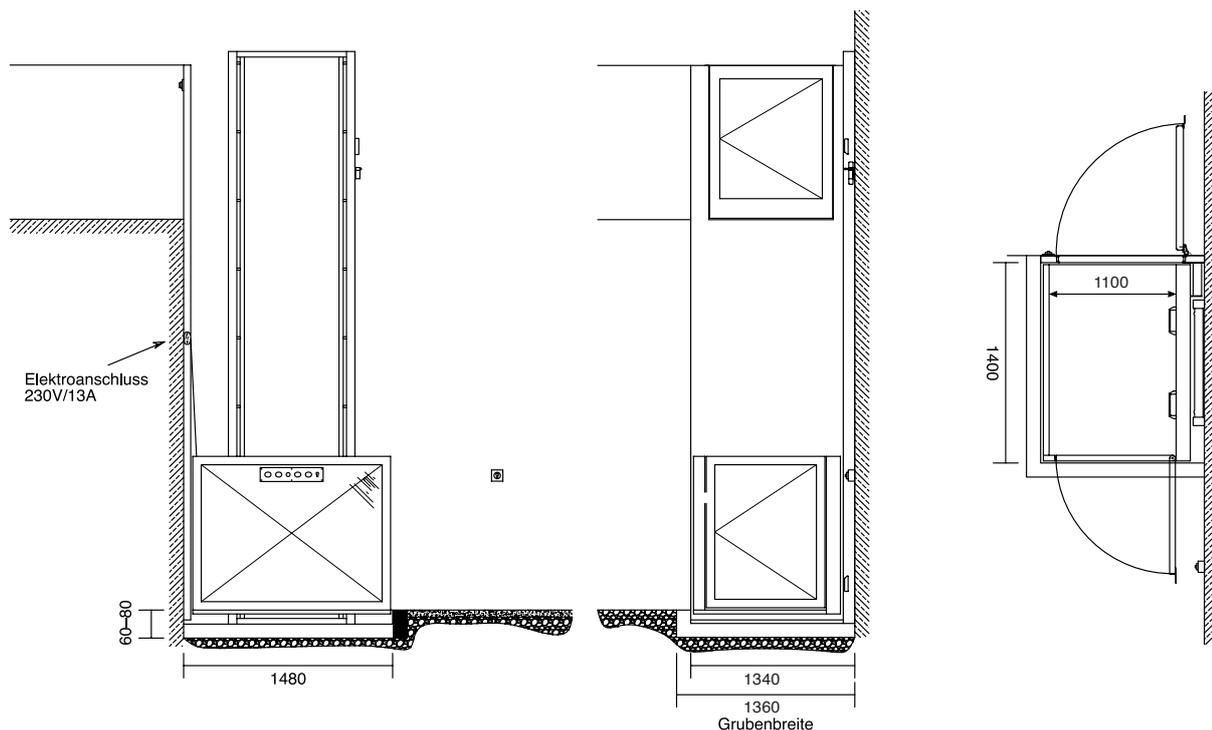
Oberer Zugang mit gesichertem Türelement
