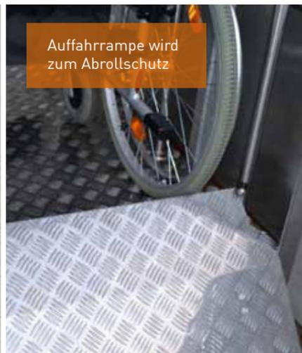
Auffahrrampe wird zum Abrollschutz
